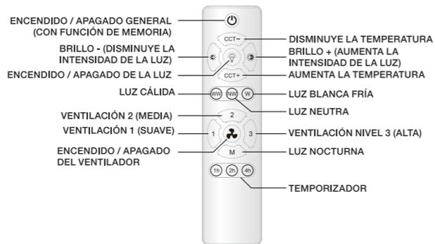
PARA UTILIZAR EL CONTROL REMOTO POR PRIMERA VEZ, ES NECESARIO EMPAREJARLO CON LA LÁMPARA. PARA ELLO, CONECTA LA LÁMPARA A LA CORRIENTE ELÉCTRICA Y MANTÉN PRESIONADO EL BOTÓN DE ENCENDIDO DEL CONTROL "ON". LUEGO DE UNOS SEGUNDOS, ESCUCHARÁS UN SONIDO "DIDI", LO CUAL INDICA QUE EL EMPAREJAMIENTO SE HA REALIZADO DE FORMA EXITOSA.
