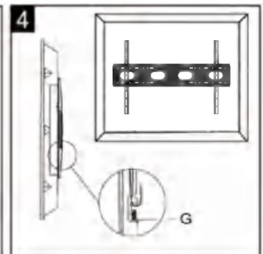
Coloca ambos ganchos del televisor con la pantalla del televisor en el soporte y luego asegura el soporte del televisor apretando el tornillo (G).
