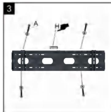
Coloca el nivel (H) en el borde superior central de la placa trasera y presiónalo hasta que esté completamente insertado. Asegúrate de que la placa trasera esté nivelada horizontalmente.
