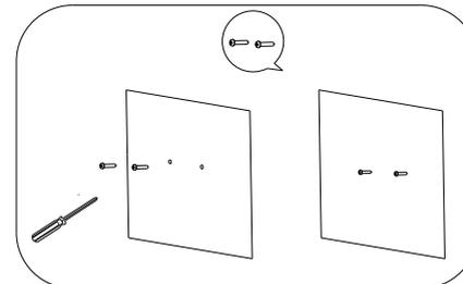
2. Fijar el soporte: Coloque el soporte en su lugar y fíjelo con los tornillos.
