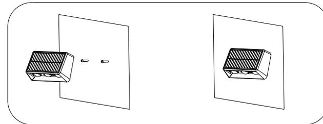
3. Instalar la lámpara: Coloque el cuerpo de la lámpara sobre el soporte y asegúrelo correctamente.
