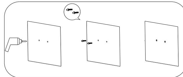
1. Marcar y perforar: Marque los puntos para los agujeros en la superficie de montaje y perforé con la broca correspondiente para insertar el tubo de expansión.
