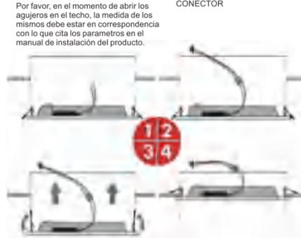
3. Tirar hacia arriba del resorte que se encuentra en ambos lados de la lámpara, incrustar de forma perpendicular la lámpara al interior de los agujeros abiertos en el techo.
