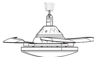
Paso 1: coloque el componente anticáida en el cuerpo de la luz
