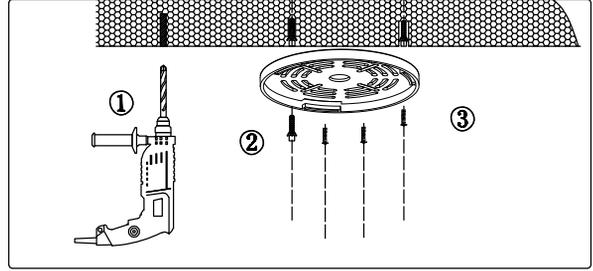
1. Primero use un taladro eléctrico de impacto para perforar 4 agujeros en la posición del techo que necesita ser instalado.
