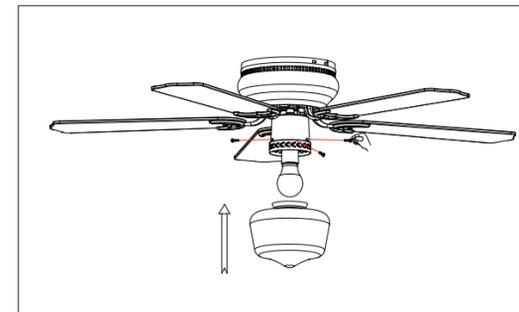
Los tres tornillos que fijan la pantalla solo se pueden bloquear con la mano, no con la herramienta.
