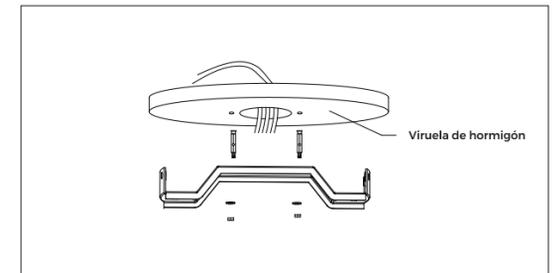
Perforar un agujero de Ø8 mm en el techo de hormigón e insertar pernos.
