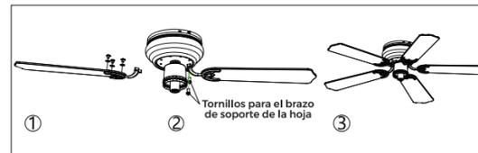
Ahorre tiempo: Las arandelas para los tornillos de las aspas se pueden colocar en cada tornillo de las aspas antes de instalar las aspas.
