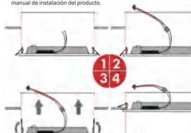
3. Tirar hacia arriba del resorte que se encuentra en ambos lados de la lámpara, incrustar de forma perpendicular la lámpara al interior de los agujeros abiertos en el techo.
