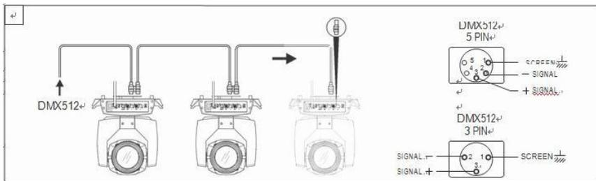
Figura1 Conexión de cable DMX
