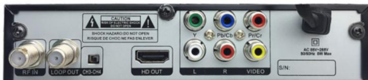
1. Entrada RF: Conecte una antena externa, de preferencia antena aérea, para obtener una señal óptima.
