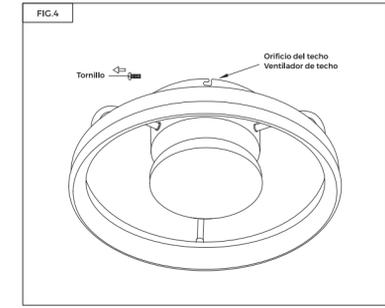
**5. MONTAJE DE LA CARCASA DEL VENTILADOR DE TECHO**
