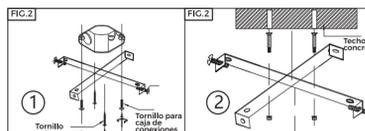
**3. PERFORAR Y ASEGURAR EN EL TECHO DE CONCRETO**
