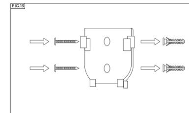
UTILICE LOS DOS TORNILLOS Y LOS ANCLAJES DE PLÁSTICO (PROVISTOS) PARA SUJETAR LA PLACA DE PARED DE MANERA SEGURA.
