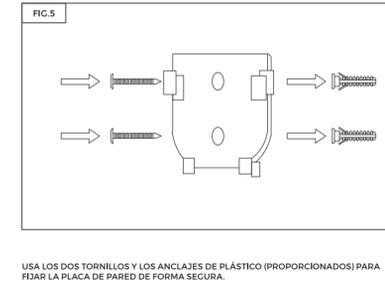
USA LOS DOS TORNILLOS Y LOS ANCLAJES DE PLÁSTICO (PROPORCIONADOS) PARA FIJAR LA PLACA DE PARED DE FORMA SEGURA.
