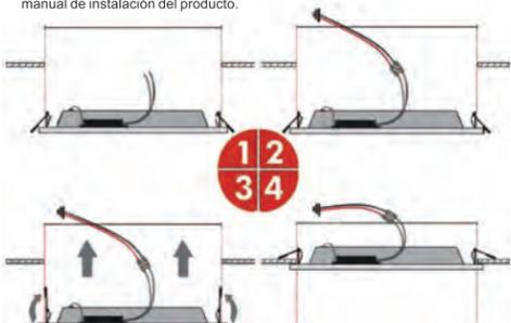
**3. Tirar hacia arriba del resorte que se encuentra en ambos lados de la lámpara, incrustar de forma perpendicular la lámpara al interior de los agujeros abiertos en el techo.**
