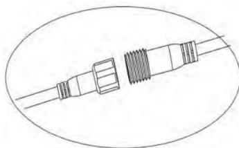
Inserte el cable de conexión y cierre el sombrero impermeable
