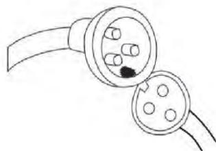
Conectar cables eléctricos(Asegúrese de conectar los cables eléctricos en la posición correcta)
