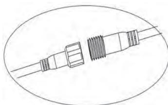
Inserte el cable de conexión y cierre el sombrero impermeable
